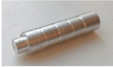
Рисунок 2. Общий вид заготовки с пятью полосами после обработки на исследуемых режимах
