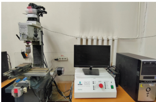
Рисунок 1. Общи вид станка Optimum BF 20 Vario, оснащенного системой ЧПУ CNC 57R
