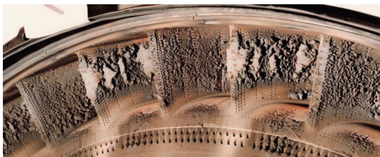
Рисунок 1. Общий вид отложений пеплового материала — двигатель RB211-524D4, вулкан Галунггунг (1982г)
