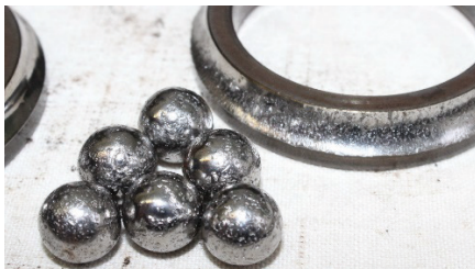
Рисунок 5. Повреждение подшипника качения из-за действия высокой осевой силы
