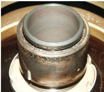
Рисунок 6. Заклинивание втулки подшипника скольжения
