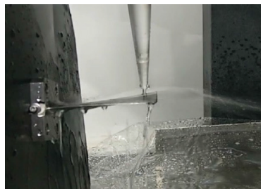
Рисунок 3. Процесс лазерного ударного упрочнения без защитного слоя (LSPwC)
