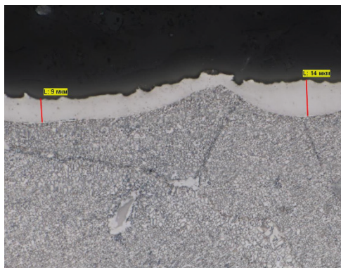
Рисунок 5. Микроструктура и толщина белого слоя образца № 1 после травления
