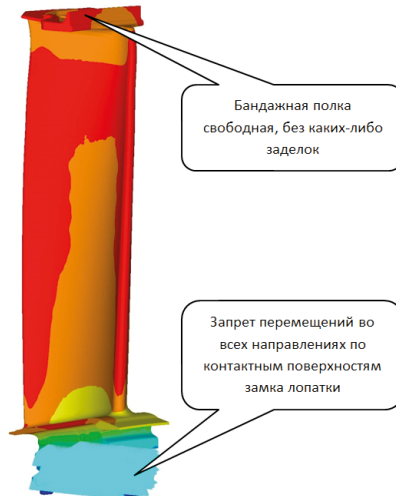
Рисунок 4. Граничные условия для проведения численного моделирования в случае отсутствия связи в бандажных полках
