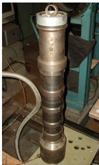
Рисунок 1. Газоимпульсная обработка металлического кольца
