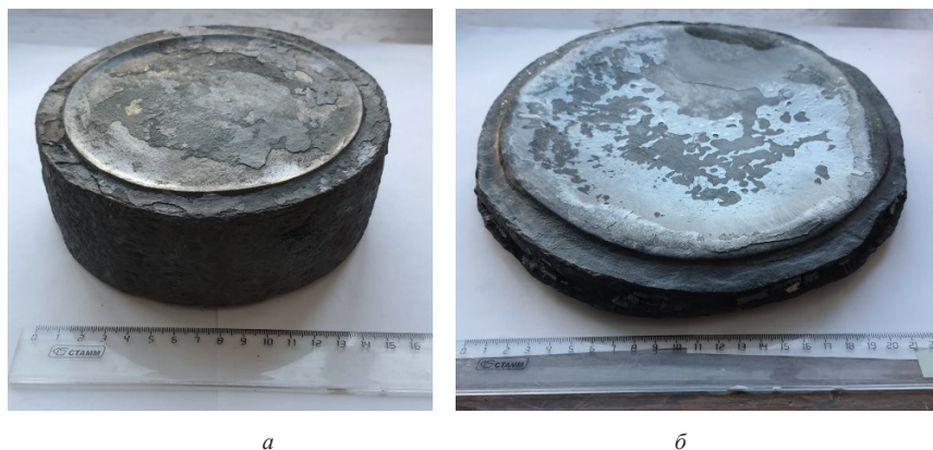
Рисунок 3. Модельные заготовки дисков из сплава ЭП975, полученные методом ГИП с последующей деформацией: № 1 ( a ) и № 2 ( б )
