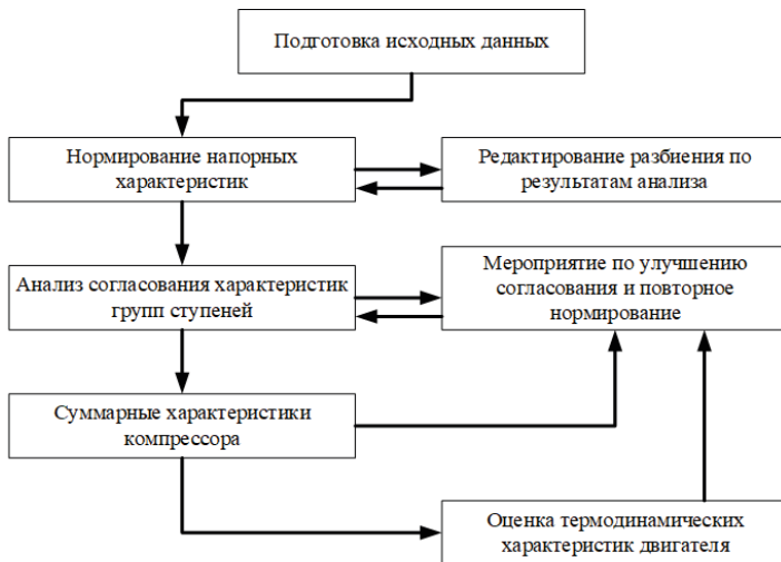
Рисунок 1. Блок-схема программного комплекса
