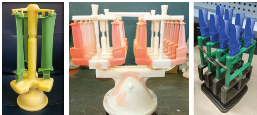
Рисунок 2. Модельные блоки отливок неохлаждаемых лопаток:
