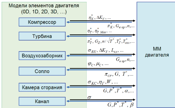
Рисунок 1. Термодинамическая ММ в двигателестроительном ОКБ
