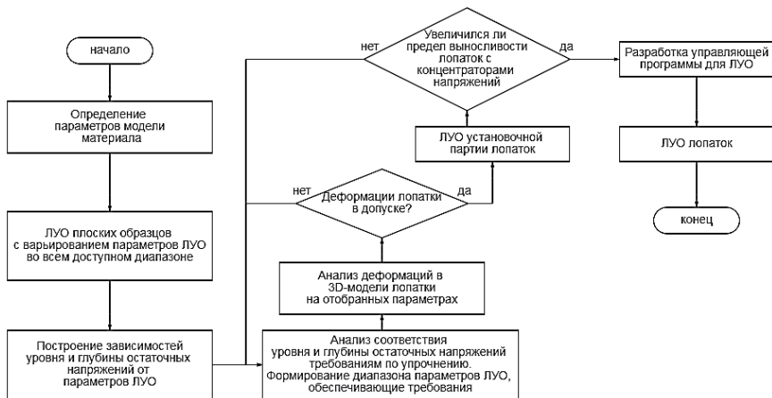
Рисунок 6. Блок-схема алгоритма определения оптимальных параметров лазерной ударной обработки на основе использования компьютерного моделирования
