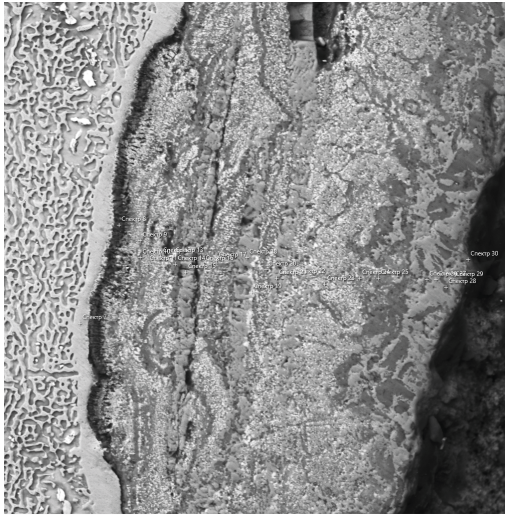
Рисунок 5. Строение «бубона» в плоскости шлифа (эксплуатация двигателя в солончаковом регионе)
