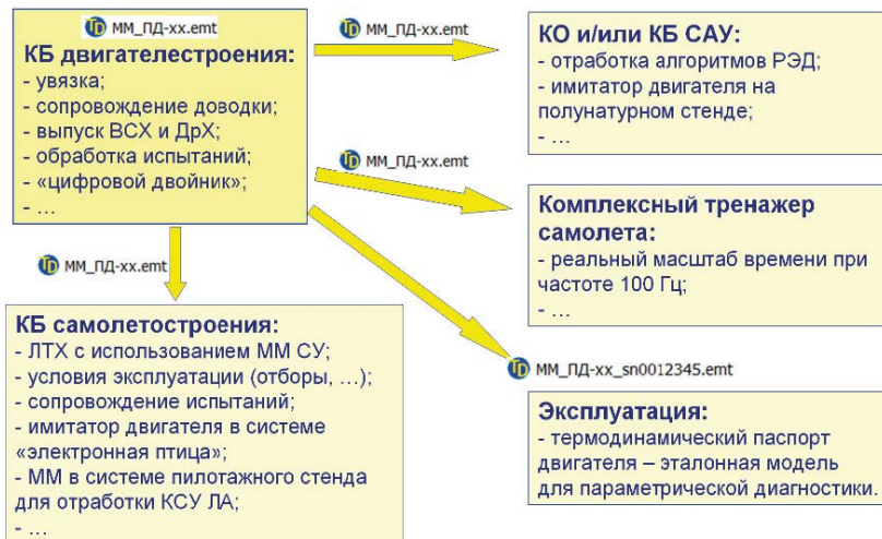
Рисунок 4. Область применения единой термодинамической ММ
